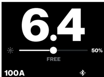
3. Drehen Sie das Dauerlicht-Einstellrad [9], um die Helligkeit in 1-%-Schritten zu ändern.
